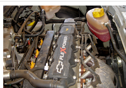
Motor típico de un vehículo de combustible flexible brasileño con el pequeño tanque de reserva de gasolina utilizado para el arranque en frío cuando la temperatura es inferior a 15° C.
